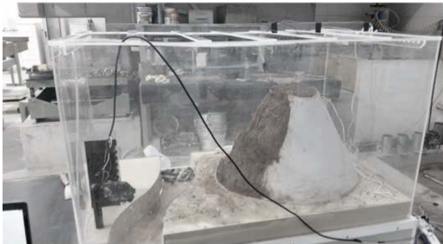
Figura 4. Imagem da maquete, com a mistura de solo aplicada e sensores posicionados
